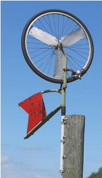
Simpel vindgenerator lavet med en cykelhjul og en dynamo.
