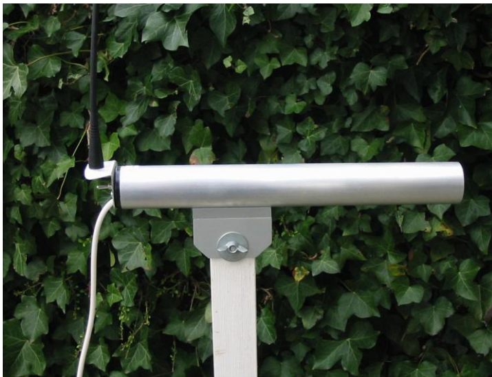
Lysmodtager med antenne
