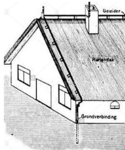
Derfor skal man passe på, at der ikke laves skarpe knæk på en lynafleder. Spændingen over induktionen kan – måske – få en gnist til
