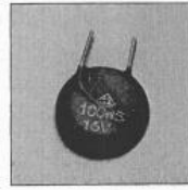
Bild 3: Die 100n sind als 100 nF zu verstehen, und das 'S' besagt -20...+50% Toleranz.
