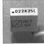
Bild 10: Folienkondensator mit Punkt, aber ohne führende Null: .022 sind 0,022 µF = 22 nF.
