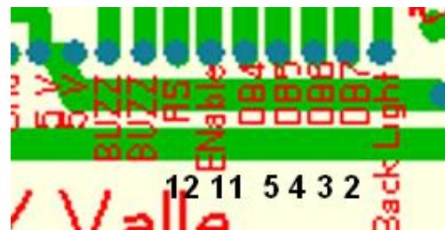
RS skal til pin Arduino pin 12, Enable til pin 11, osv.
