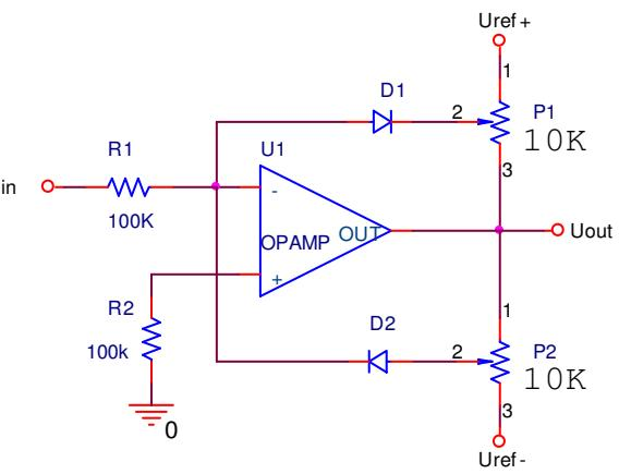
Spændingskontrolleret saturation niveauer.
